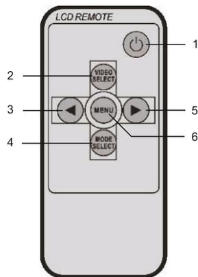
1. Включение/Выключение монитора
